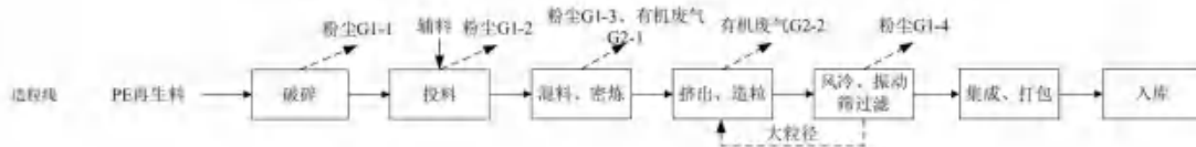
图3-3 造粒线生产工艺流程及“三废”排放点位图
