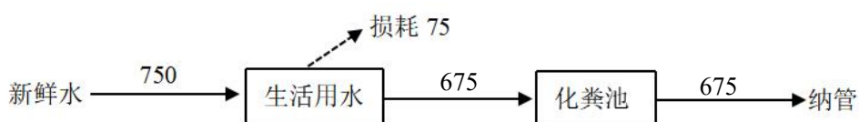
图 3-2 本项目水平衡图（t/a）
